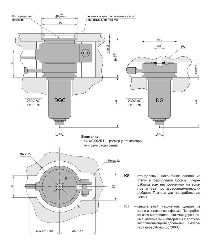
Стандартные дюзы DGC и DG снабжены спиральным нагревателем GS. Возможно снабжение дюз трубчатым нагревателем GT, который рекомендуется при переработке материалов чувствительных термически и технических материалов (стр. 32)
